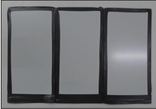
Foto 2 – Chapa metálica antes do ensaio
