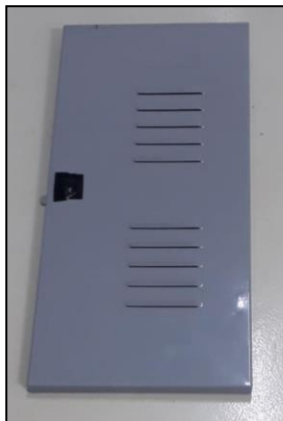
Foto 3 – Porta do armário antes do ensaio com regiões com solda
