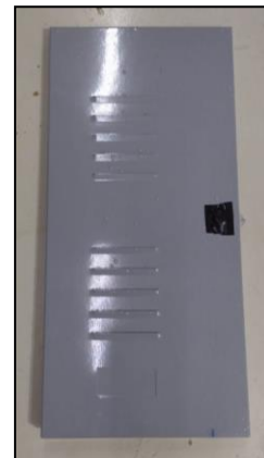
Foto 4 – Porta do armário após 1272 horas em exposição com regiões com solda
